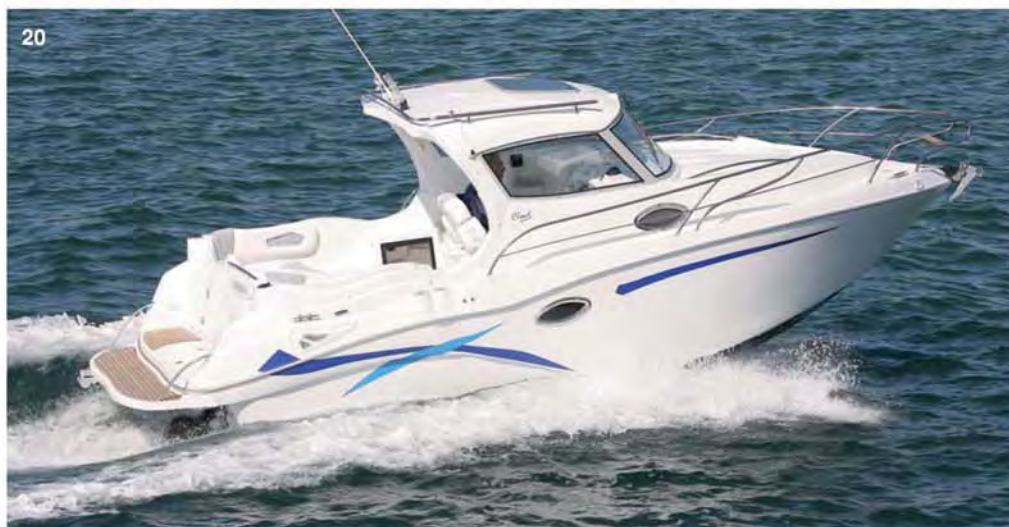
20. La Lema Clon S alcanzó con el motor Volvo Penta GXi DPS de 225 Hp una velocidad máxima de 33,7 nudos a 4.600 rpm.
