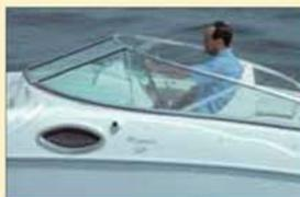
El parabrisa no es de metacrilato sino de cristal Securit® curvado y robustamente anclado a la cubierta. Además protege perfectamente de viento y rociones al piloto.
