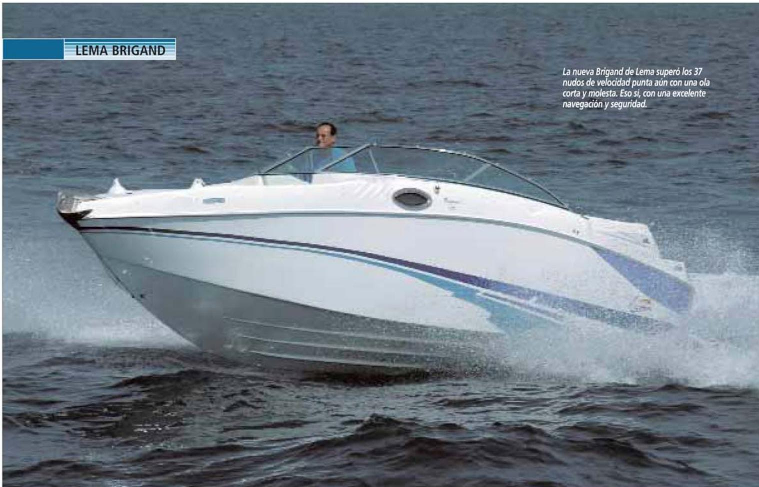
La notable manga de 2,70 m le confiere una estabilidad fuera de lo común en un casco con V profunda a proa. A estribor de la plataforma se observa la escalera de baño escamoteada bajo la misma.
